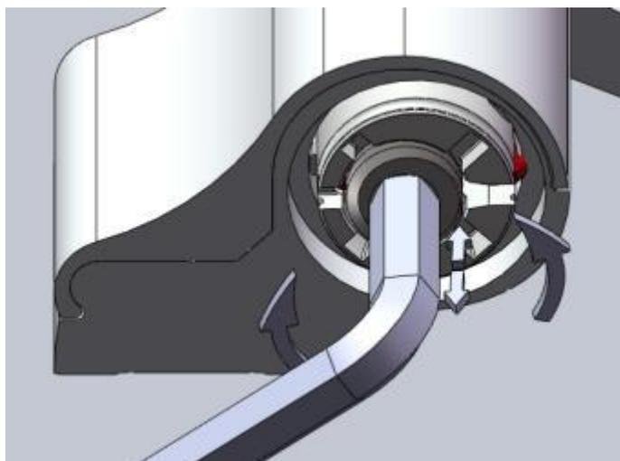
Durch Anziehen der Innensechskantschraube M12 erfolgt die stufenlose vertikale Regulierung (+ 4mm).
