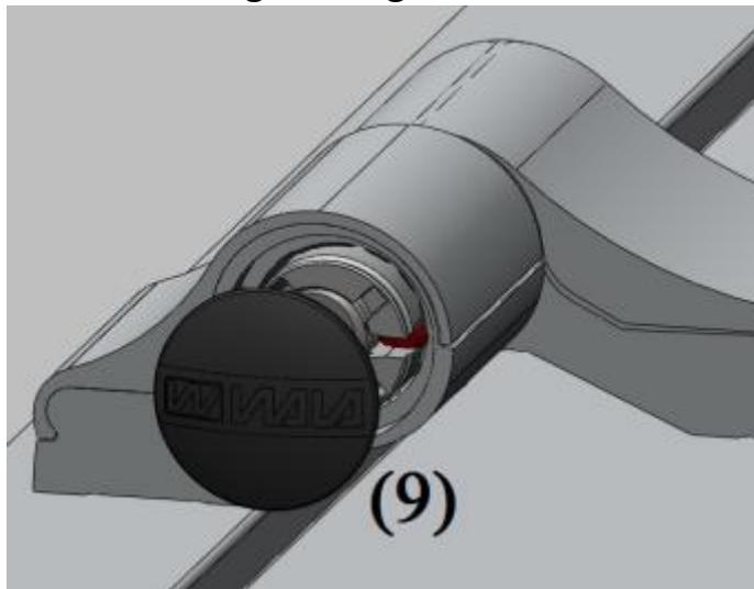
Nehmen Sie die untere Verschlusscheibe (9) ab, z.B. indem Sie diese mit einem flachen Schraubendreher anheben.
