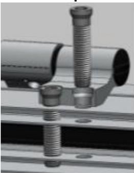
Percer des trous de  $\phi$  11 mm dans 3 des parois du profilé.
