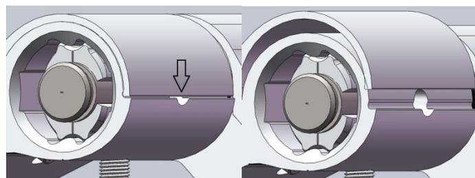
Используя технологическое отверстие, поднять маскирующую накладку плоской отвёрткой для получения доступа к регулировке.
