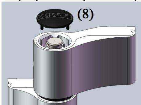
Снять заглушку (8) (например, поддев её плоской отвёрткой).
