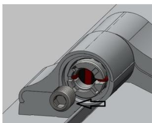
Полностью отвернуть прижимной винт M12.
