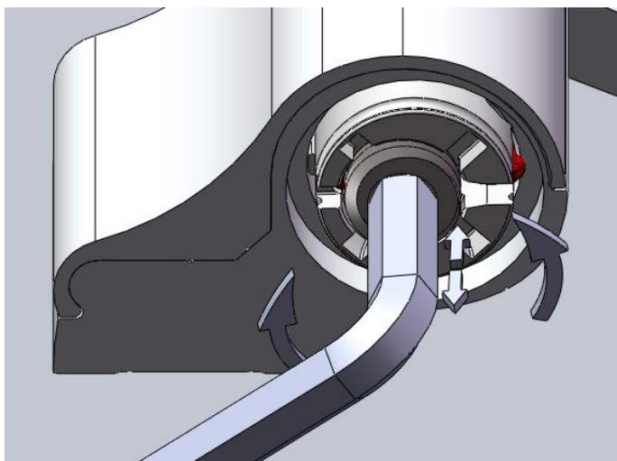
При завинчивании прижимного винта M12 происходит плавная регулировка по вертикали (+ 4 мм).
