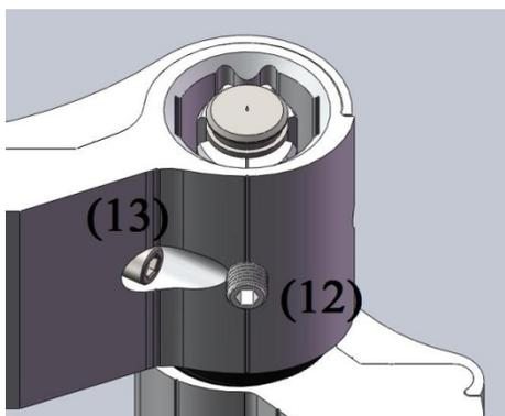
При открытой двери ослабить болт М4 (13), фиксирующий маскирующую накладку, и ослабить прижимной винт М6х5 (12).
