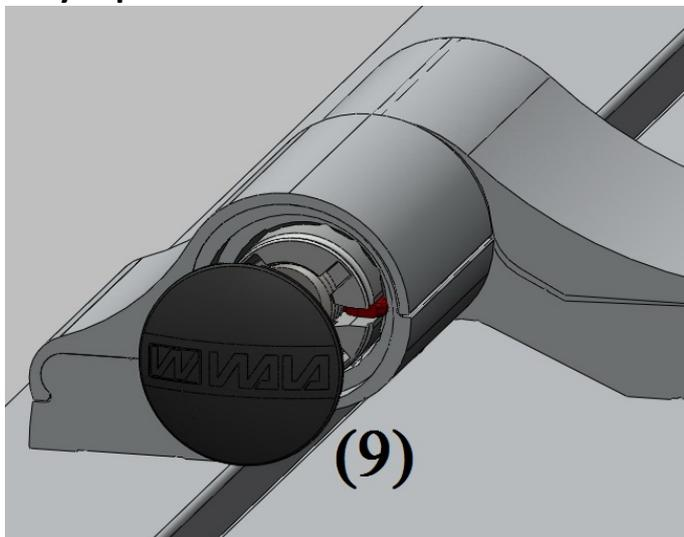
Снять заглушку (9) (например, поддев её плоской отвёрткой).
