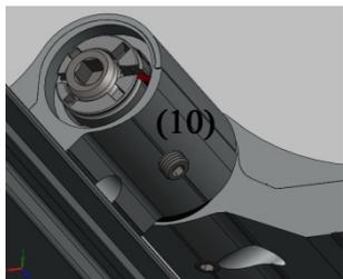
При открытой двери ослабить прижимной винт M6x5 (10).
